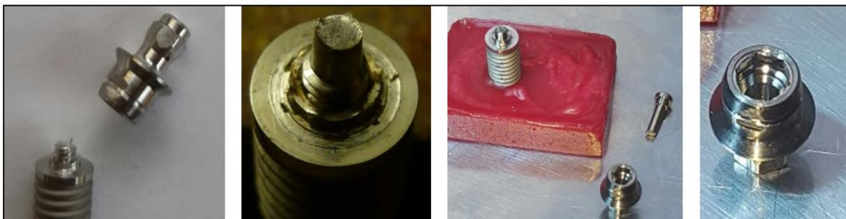
Figura 5. Ejemplificación de falla: Grupo 5 de implantes Biomet 3i. Fractura del tornillo del portaimplante por encima del nivel del hexágono que permite observar los ángulos falseados tanto del implante como del portaimplante.
