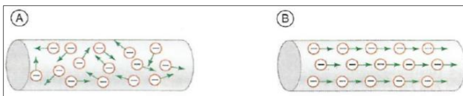
FIGURA 1. Representação esquemática do movimento dos elétrons livres em um fio metálico: (A) movimento caótico dos elétrons; (B) movimento ordenado dos elétrons. Fonte: Torres et al. (2016, p. 46, Figura 1.41).
